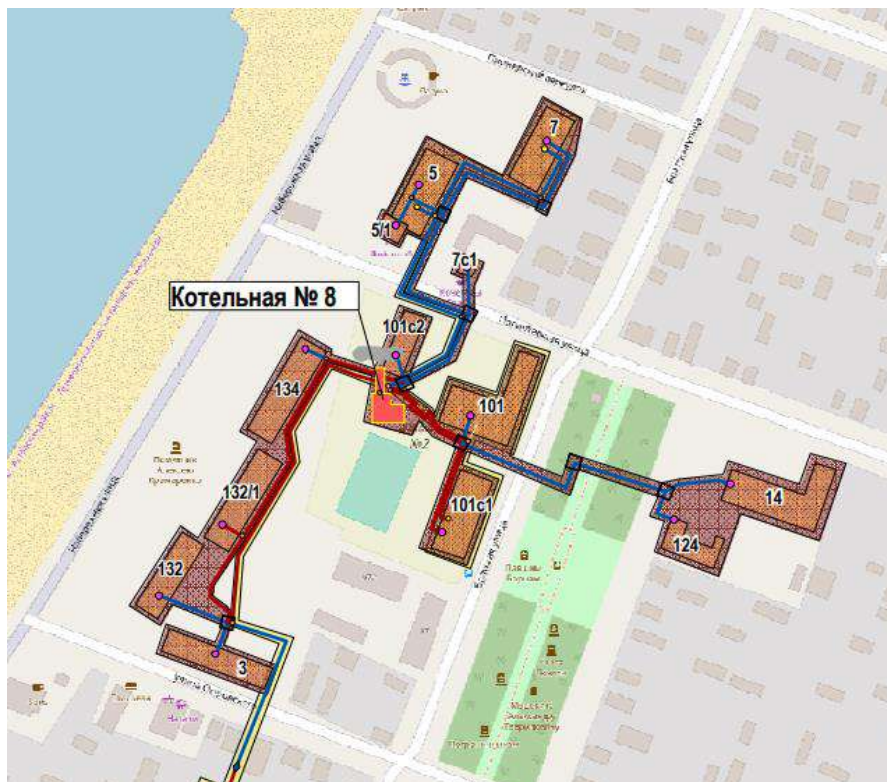
Рисунок 6 -Зона действия котельной № 8, ул. Братская 101
