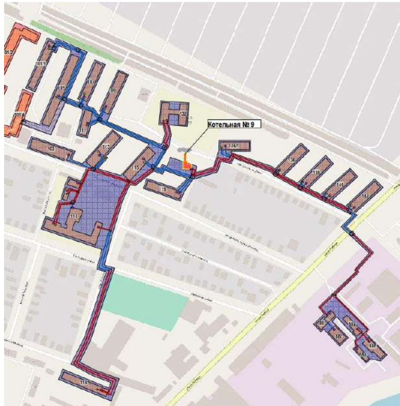
Рисунок 23 -Зона действия котельной № 9, ул. Ком.Шевченко 117
