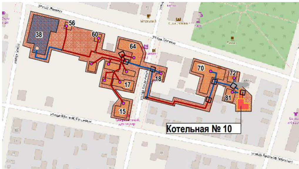
Рисунок 24 -Зона действия котельной № 10, ул.Ленина 74
