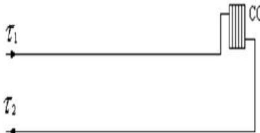
Рисунок 17 – Схема присоединения теплотребляющих установок потребителей к тепловым сетям
