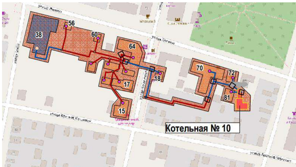
Рисунок 7 -Зона действия котельной № 10, ул.Ленина 74
